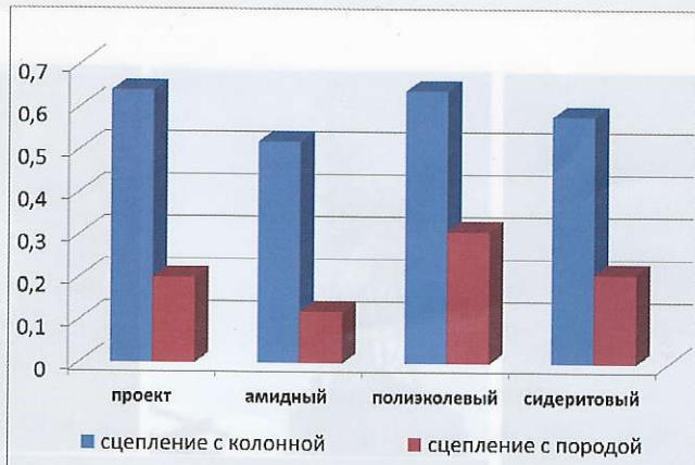
**Рис. 5.** Средний коэффициент качества цементирования кондукторов
